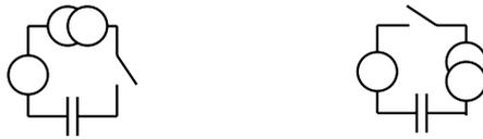
FIG. 3.4 – Deux circuits électriquement équivalents.
